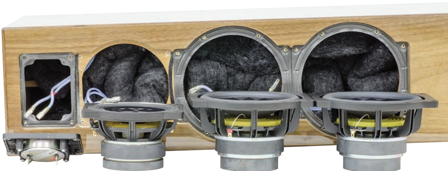
Il diffusore smontato, ovvero con tutti gli altoparlanti in bella posa. Notiamo le dimensioni del tweeter, il midrange che sembra una copia rimpicciolita del woofer ed i due trasduttori per le note basse. Notate come sia il midrange che i due woofer siano dotati di secondo magnete.
