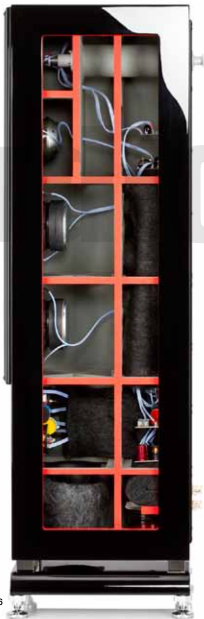
6. FS 509 VX-Jet的內部結構，可以看到向下發射的低音反射孔的位置。
