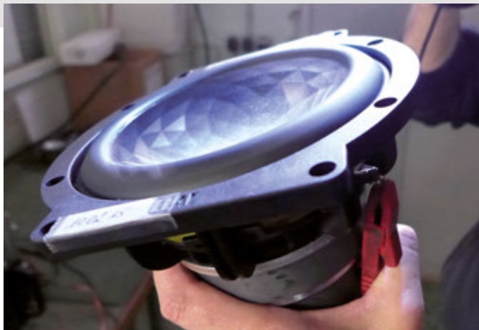
Un woofer Elac esaminato con luce stroboscopica. Impressionante l'escursione del cono.
