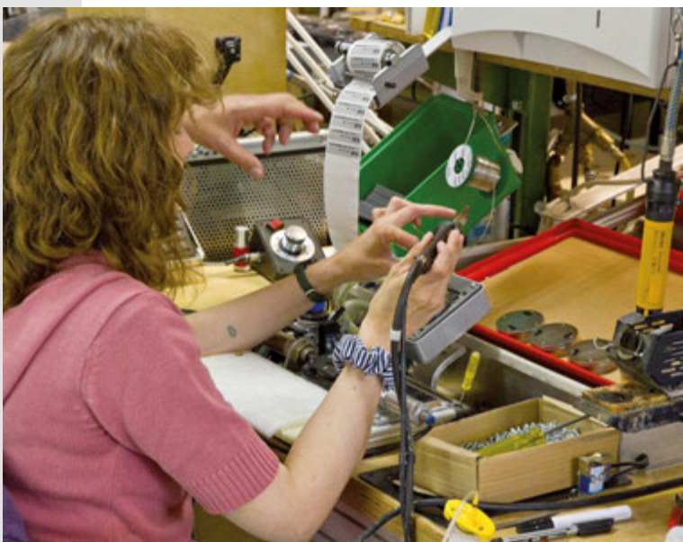
Fasi di produzione dello speciale tweeter "JET", che la Elac utilizza nei modelli più importanti e rende disponibili anche per altri costruttori.
