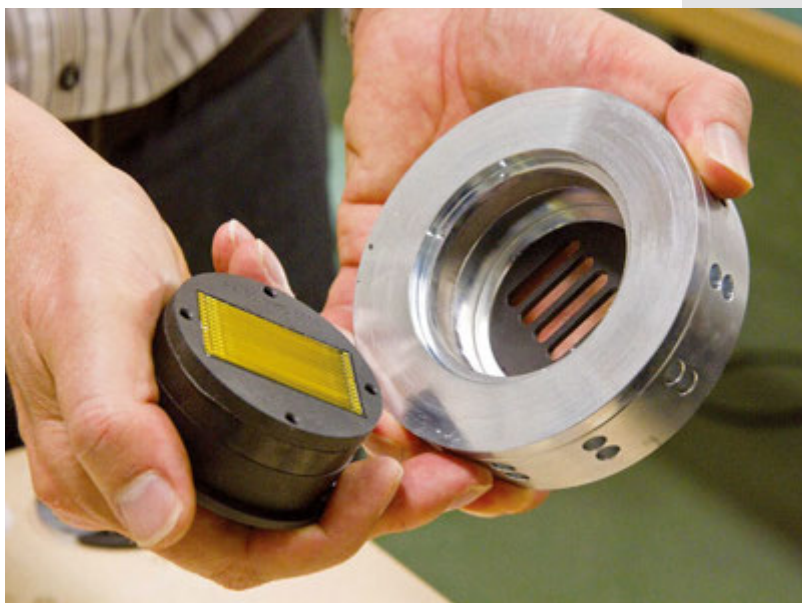
Fasi di produzione dello speciale tweeter "JET", che la Elac utilizza nei modelli più importanti e rende disponibili anche per altri costruttori.
