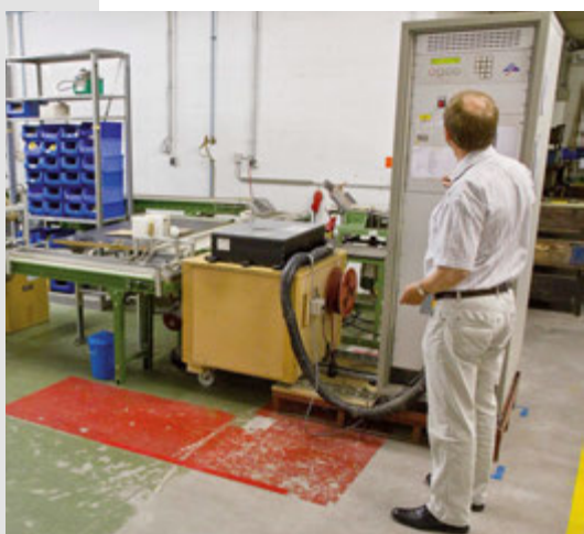
La strumentazione utilizzata per la magnetizzazione degli altoparlanti.
