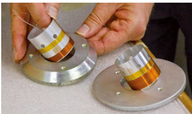
Questa è la fase in cui le bobine vengono montate nei driver.
